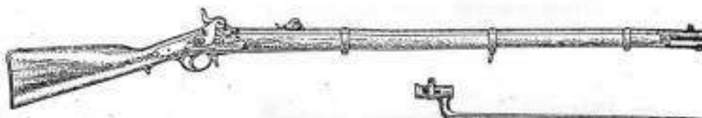
Русская 6-линейная винтовка образца 1856 г. Рядом – трехгранный штык.
