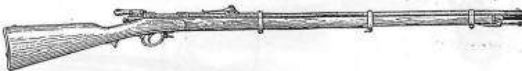
Игольчатая винтовка Карле 1867 г., принятая на вооружение в России.
