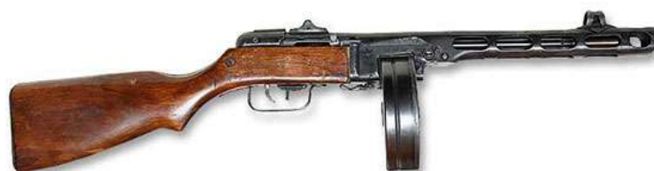
7,62-мм пистолет-пулемет обр. 1941 г. конструкции Г. С. Шпагина ППШ
